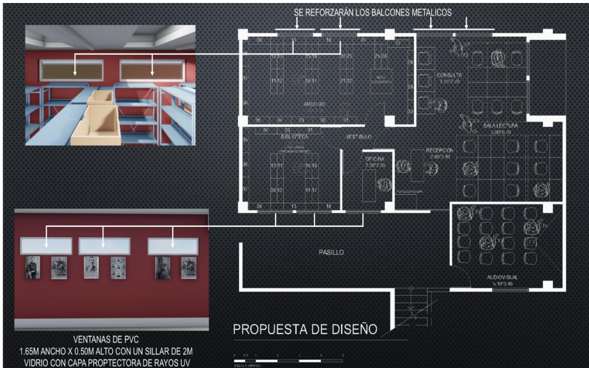
Ilustración 7 Seguridad en ventanas y balcones AHMS
