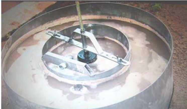
Ilustración 9 Infiltrómetro doble anillo
