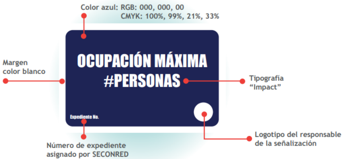
Figura 32. Rotulación de la carga ocupacional máxima
