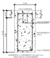
SECCIÓN "Orilla" VIGA V-1
