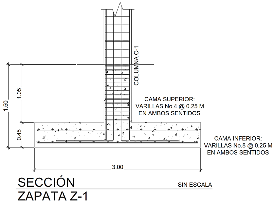
Sección de zapata Z-1
