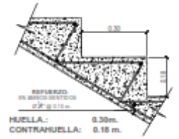
DETALLE 1 ESCALÓN DE GRADA
